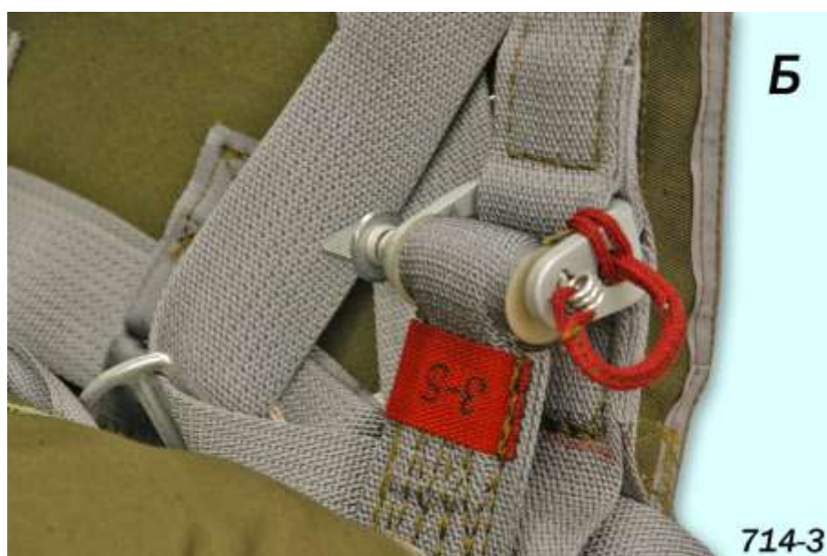
Рисунок 27Б – Присоединение запасного парашюта
