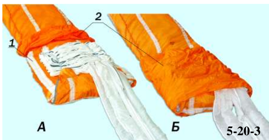
Рисунок 21 – Укладка строп в соты чехла
